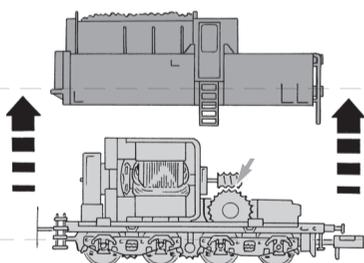
Beim Aufsetzen des Gehäuses ist darauf zu achten, dass die im Tendergehäuse eingienietete Kontaktfeder nicht verbogen wird!
